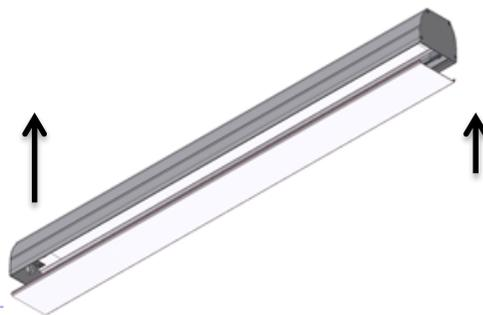
При построении непрерывной световой линии, длиной более 10 м, возможны температурные деформации корпуса и рассеивателя светильника при изменении окружающей температуры. Так как коэффициенты температурного расширения корпуса светильника и рассеивателя разные, деформация рассеивателя может привести к его выщелкиванию или даже выпадению. Для предотвращения выщелкивания, при установке рассеивателя необходимо оставлять зазор между торцом рассеивателя и торцевой крышкой светильника (2-3 мм).
