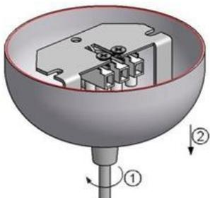
Установить втулки подвеса и пластик потолочной чашки на поверхности потолка, продеть концы тросов через отверстия в крышках втулок подвеса и закрепить их во втулках. Для светильников с регулируемым ЭПРА установить вторую потолочную чашку для управляющего кабеля.
