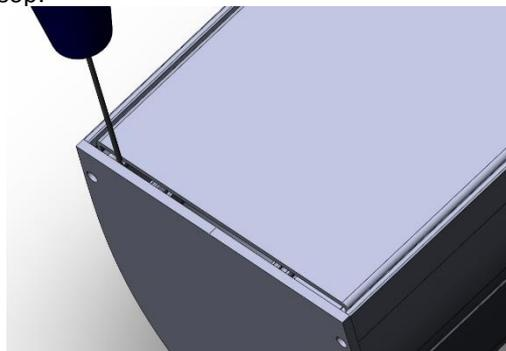
Вставить плоский шлиц отвёртки возле края рассеивателя на максимальную величину, не оказывая давление на рассеиватель с торца.
