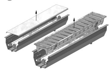
**2** Открутив винты, снять алюминиевый отражатель:
