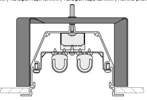
5 Подключить сетевой провод к клеммной колодке в соответствии с указанной полярностью
