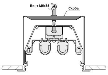
Закрутив винты до упора, зафиксировать светильник:
