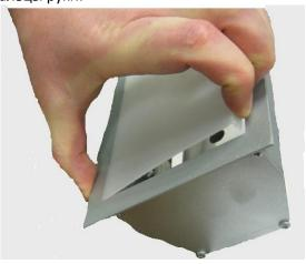
Аккуратно сдавливая рассеиватель в поперечном направлении и нажимая на него сверху пальцами руки, вынуть рассеиватель из светильника.
