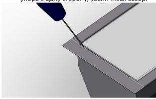
вставить плоский шлиц отвёртки возле края рассеивателя на максимальную величину, не оказывая давление на рассеиватель с торца.
