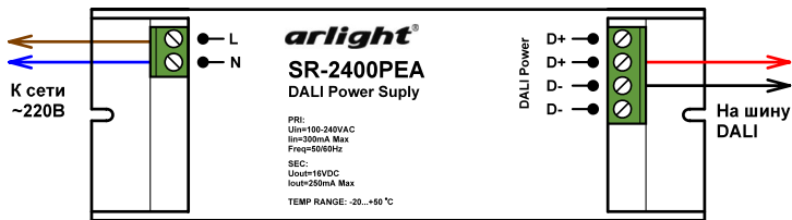
Рис.2. Подключение блока питания ARV-SR-2400PEA.
