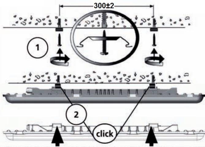
Установка на потолок с использованием поворотного кронштейна:
